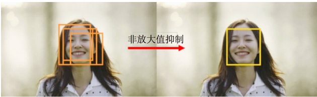
图 7 非极大值抑制去除冗余候选框
