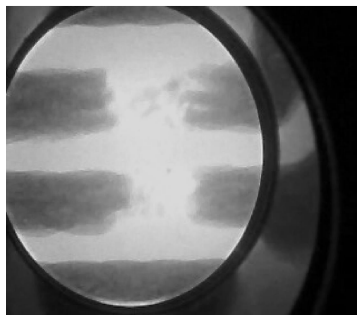
图 3 第三断绳区 X 光影像
