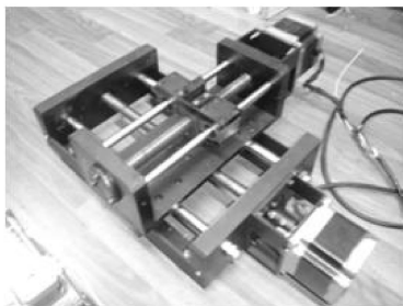
图 5 高精度探针移动机械系统实物图
