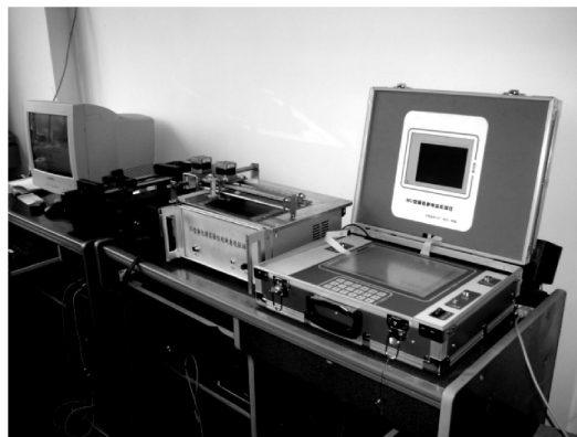
图1 基于触摸屏技术的模拟静电场测绘仪系统实物图
