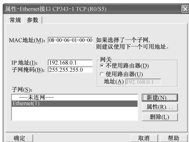
图3 下位机的以太网通信设置示意图
