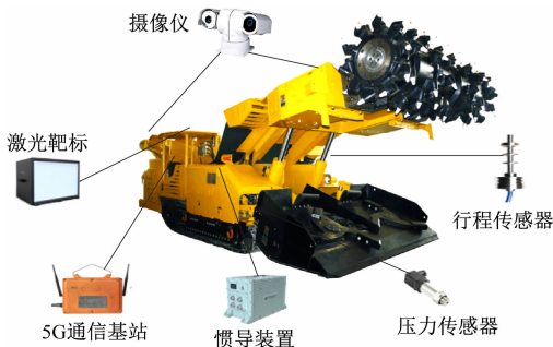
图 2 掘进机器人感知元件分布
