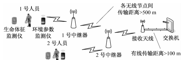
图2 基于 Mesh 多跳和 FHSS 技术的无线通信系统结构
