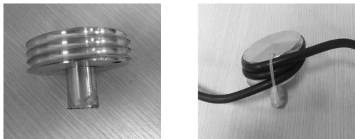
(a) 装置实物 (b) 光缆固定示意 图 2 螺旋形机械装置
