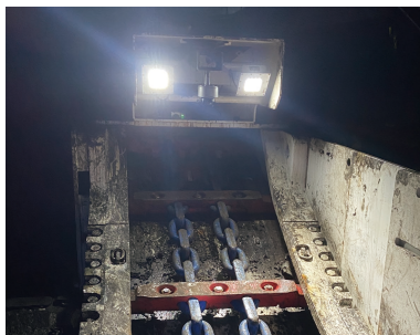
图 5 刮板输送机断链智能监测 AI 摄像机布置
