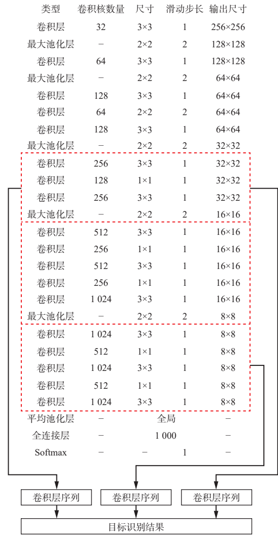
图 1 改进YOLOv3结构和具体参数
