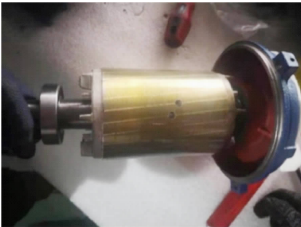
(a) 转子断条故障
