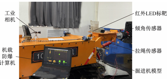
图 5 悬臂式掘进机截割头位姿视觉测量实验平台
