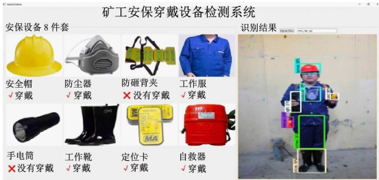
图 4 矿工安保穿戴设备检测系统监控界面
