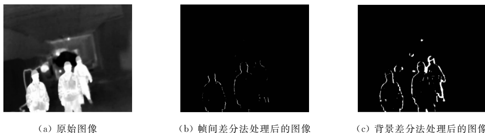
图4 采用帧间差分法与背景差分法得到的图像处理结果
