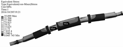
图 9 偏心轴的应力分布云图
