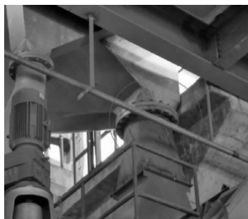
图10 棒磨机出料口安装效果
