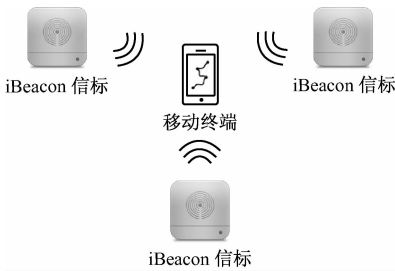
图 1 iBeacon 室内定位系统组成
