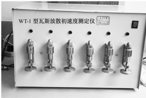
图 1 WT-1 型瓦斯放散初速度测定仪
