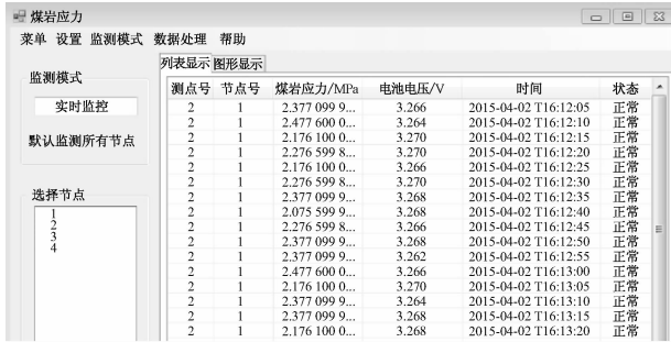
图 7 煤岩应力分布式监测系统上位机界面
