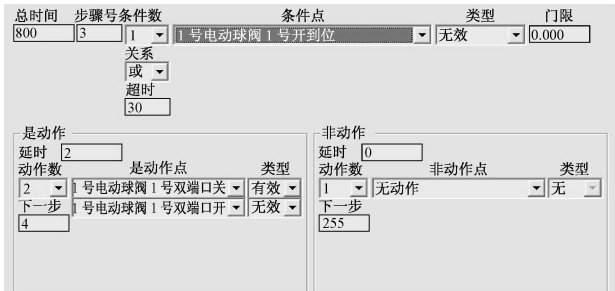
图 2 用于水泵控制的一个控制步骤行的配置界面
