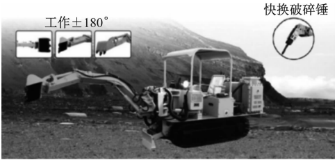
图 3 WPZ-30/400 型煤矿用巷道修复机
