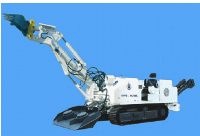
图 5 WPZ 型煤矿用巷道修复机
