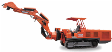
图 7 WPZ-37/600 型煤矿用巷道修复机
