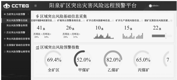
图 5 阳泉矿区瓦斯灾害风险预警数据采集试验效果
