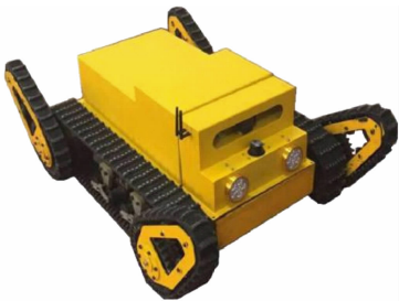
图 4 煤矿巡检机器人
