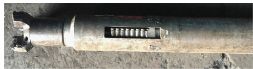
图4 试验完成后的掏穴钻头
