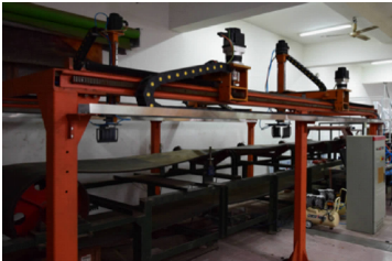
图 11 桁架式双机械臂分拣机器人样机 Fig. 11 Truss double-manipulator sorting robot prototype
